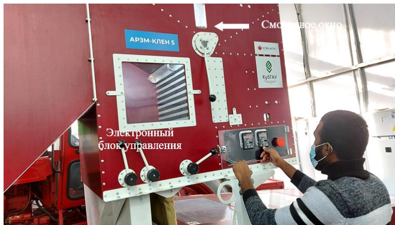
Рисунок 6 – Смотровое окно и электронный блок управления
