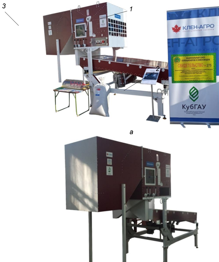
Рисунок 4 – Общий вид аэродинамической решетчатой зерноочистительной машины: а – вид спереди; б – вид сзади
