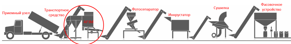
Рисунок 1 – Схема семяочистительного селекционного комплекса
