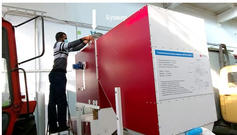
Рисунок 5 – Загрузка материала в бункер
