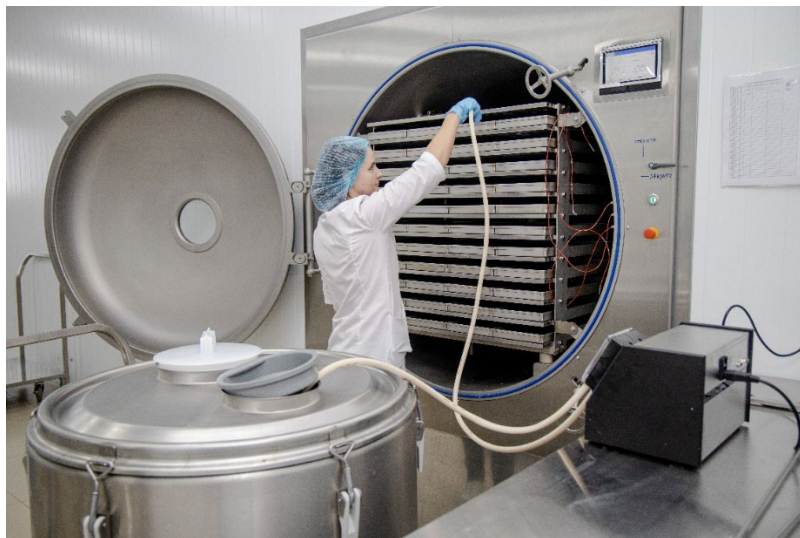
Рисунок 4 – Процесс сублимации кобыльего молока
