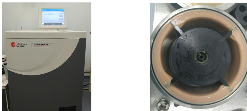
Рисунок 2 – Проточная центрифуга и сконцентрированная бактериальная масса
