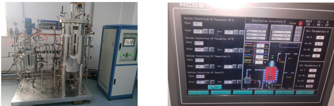
Рисунок 1 – Биореактор для суспензионного культивирования, с автоматической панелью управления
