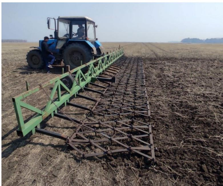
Рисунок 6 – Новое орудие с модернизированными зубвыми рабочими органами в агрегате с трактором МТЗ-82
