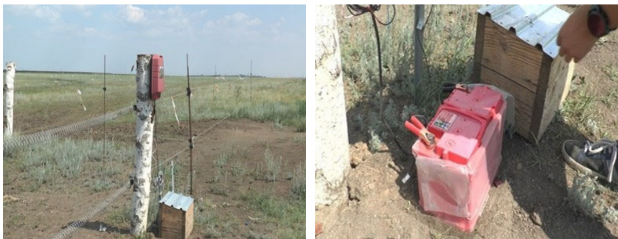
Рисунок 3 – Электрическая изгородь с системой питания аккумуляторами и солнечными батареями для ограждения пастбищной территории и участков
