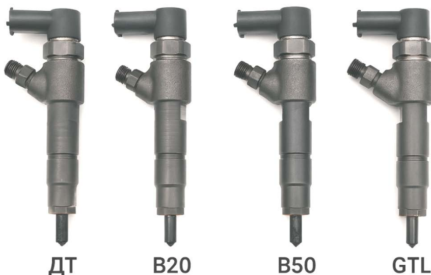
Рисунок 4 – Сравнение форсунок после работы на разных смесях
