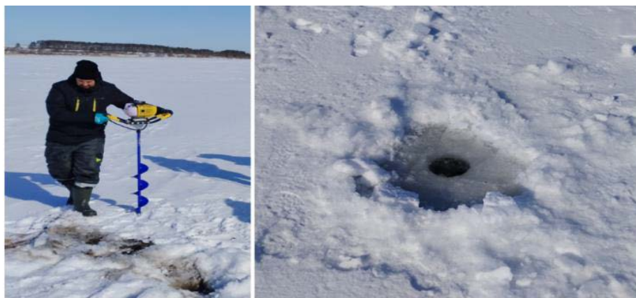
1 Сурет – Бензин қозғалтқышы бар бұрғы. Диаметрі 0,2 м мұздағы дайын тесік
