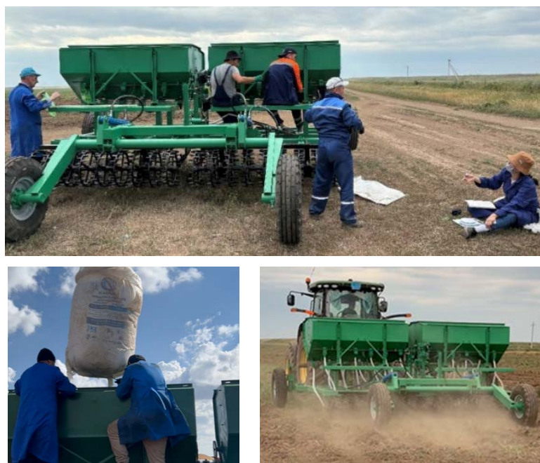
Рисунок 4 – Экспериментальный образец чизельного глубокорыхлителя удобрения и полевые испытания
