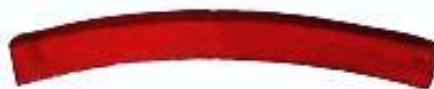
1-сурет – Эллиптикалық сызық бойымен жасалған айналмалы жұмысшы бөліктің кескіш пышағының физикалық моделі
