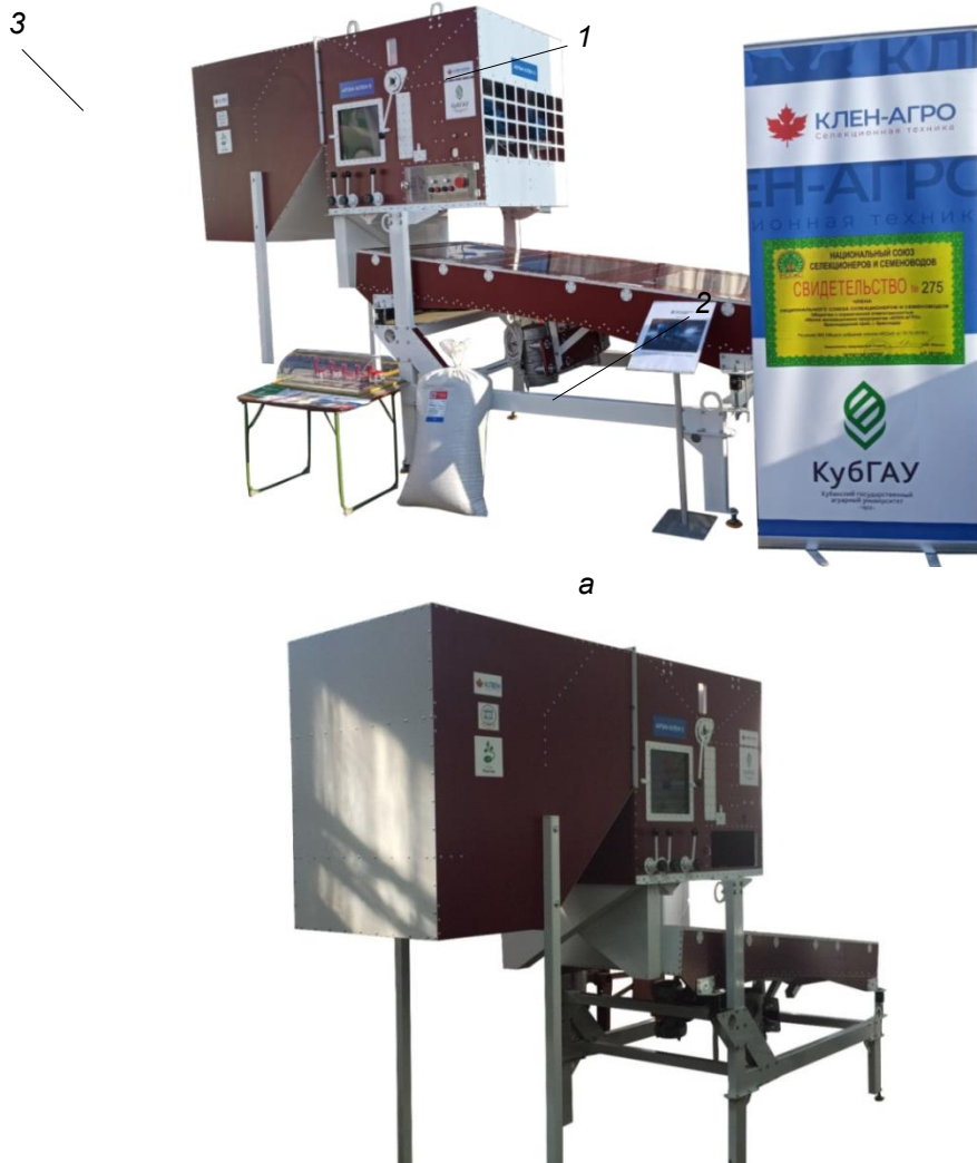
Рисунок 4 – Общий вид аэродинамической решетной зерноочистительной машины: а – вид спереди; б – вид сзади
