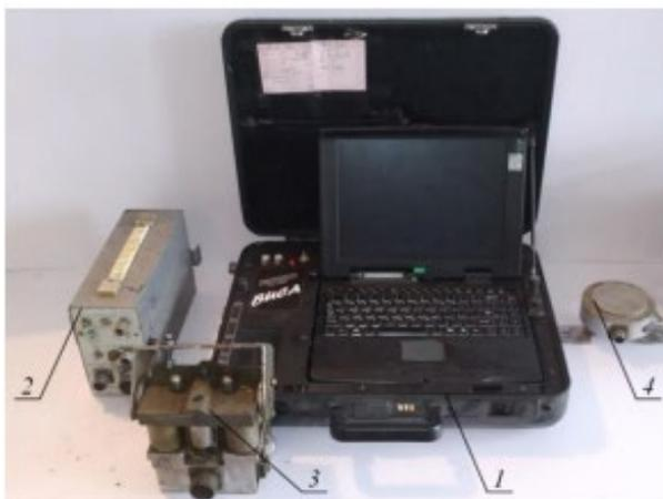
Рисунок 1 – Оборудование для измерения расхода топлива
