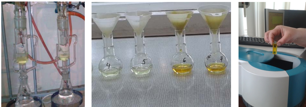
Рисунок 1 – Спектрофотометрический метод определения рутина.
