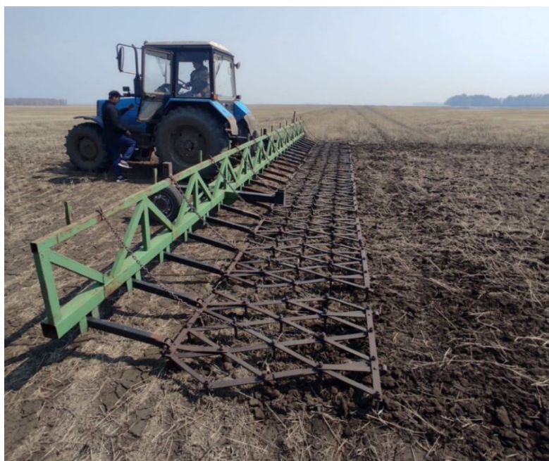
Рисунок 6 – Новое орудие с модернизированными зубвыми рабочими органами в агрегате с трактором МТЗ-82
