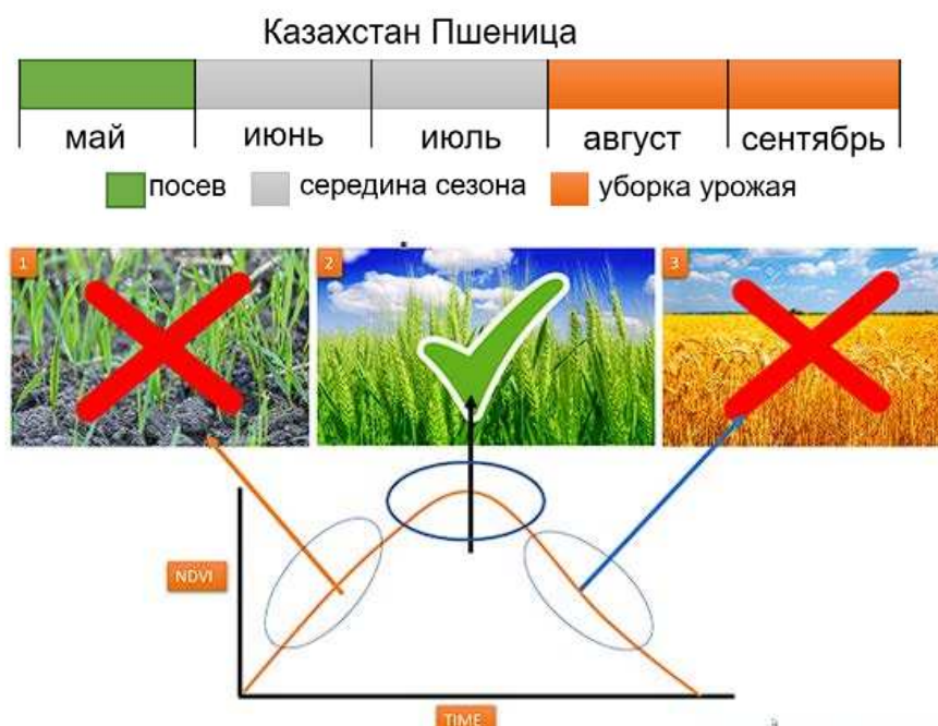
Рисунок 2 – Определение оптимального периода для расчёта NDVI на основе фаз вегетации пшеницы
